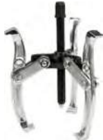
Знімач підшипників 3-лапковий
