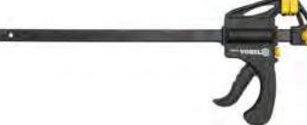
Струбцина "автомат" пластикова
