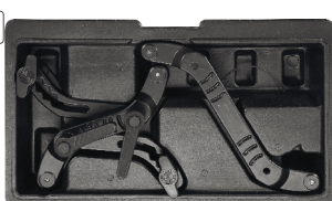
Фіксатори розподільного валу ГРМ для дизельних і бензинових двигунів
