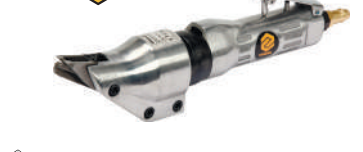
Ножіці пневматичні матричні 1/4" 3500 різ/хв, до стал. листів h≤1.5 мм P=0.62 МПа, 113 л/хв
