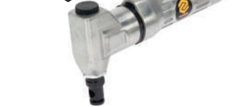
Ножіці пневматичні матричні 1/4" 3500 різ/хв, до стал. листів h≤1.5 мм P=0.62 МПа, 113 л/хв
